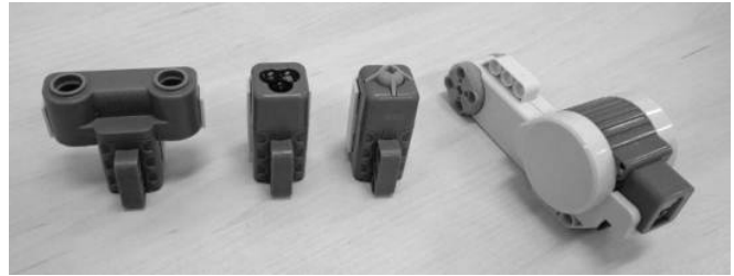
Figura 2. Sensor ultrassônico, sensor de intensidade luminosa, sensor de toque e motor da plataforma Lego Mindstorms.
