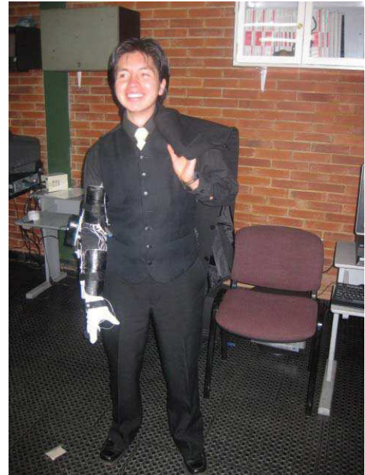
Figura 5. Exoesqueleto desarrollado que permite manejar el brazo robótico, cuenta con cuatro sensores, uno para cada articulación que maneja el robot.
