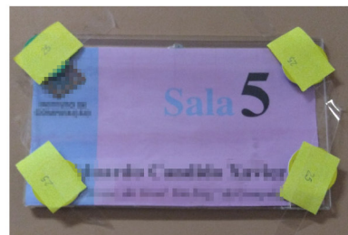
Figura 7. Etiquetas NFC posicionadas em uma das salas. Fonte: dos autores.
