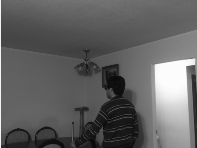
Figura 8. Prototipo. El usuario sostiene un bastón con un emisor infrarrojo. Al fondo (sobre pedestal de madera) se encuentra un Wiimote captando los datos de posición y desplazamiento
