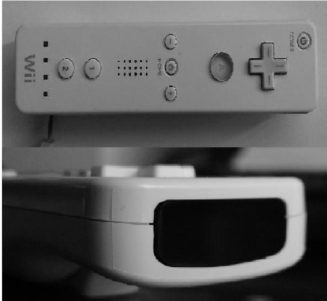
Figura 1. (Arriba) Vista superior del Wiimote. (Abajo) Vista frontal con cámara infrarroja del Wiimote en primer plan
