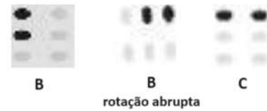
Figure 7. Exemplo de ruído gerado por rotação abrupta de caractere Braille
